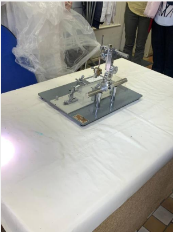
Станок, используемый для удержания головы крысы во время операций
